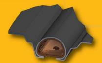
In das dünnwandige Aluminiumblech wird eine speziell geformte Rille gepreßt. Nach der selektiven Beschichtung wird das Wärmeträgerrohr in die Rille eingelegt und unter hohem Druck verpreßt.
